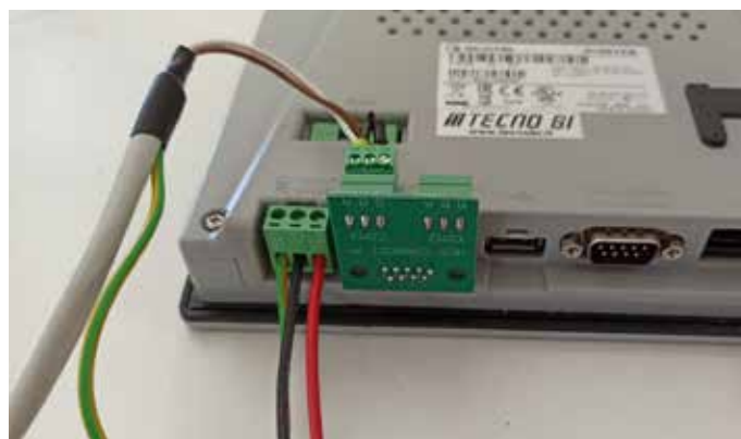
⑥ Підключення сенсорної панелі НСС
