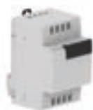
I moduli EMM e EMT sono dispositivi elettronici che comunicano con BUTLER via cavo seriale e permettono di misurare l'energia elettrica assorbita della pompa di calore INNOVA. Attraverso l'apposita schermata di interfaccia del BUTLER è possibile analizzare i consumi elettrici e migliorare le impostazioni di comfort per ottimizzare i consumi. Installazione EMM su barra DIN 35 mm - 2 moduli DIN. Installazione EMT su barra DIN 35 mm - 4 moduli DIN.
