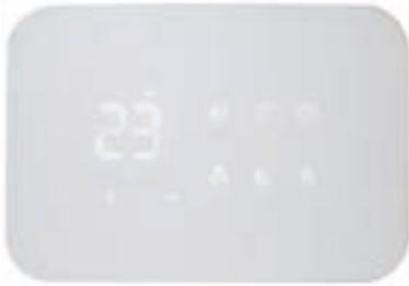
Nuova serie, nuovo design, nuove funzionalità: con soli 5 mm di profondità, finalmente una versione assolutamente ultrapiatta ( si monta in scatola 503). Il termostato rileva la temperatura ambiente ed il grado di umidità e permette di impostare la temperatura desiderata e la velocità del ventilatore. Il modello EEB749II comunica con BUTLER via cavo seriale ModBus
